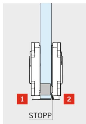
MUNDUS kann auch nachträglich durch den Austausch von existierenden Eckbeschlägen leicht in bestehende Anlagen integriert werden.
