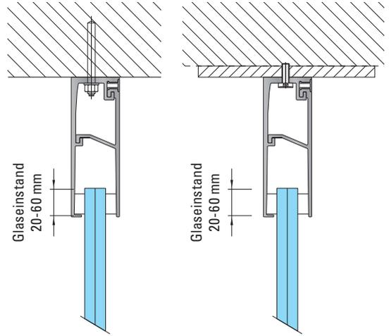
Zur **Decken**montage seitlich an den Baukörper oder eine bauseitige Unterkonstruktion
