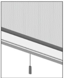
Damit der Schlusstab auch bei größeren Höhen erreicht werden kann, wird standardmäßig eine Zugschnur mit Griffmuschel mitgeliefert.
