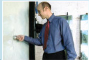
Test der in dem CRD (Forschungs- und Entwicklungszentrum von Glaverbel) ausgeführt wird. Aufprall eines Pendels von 45 Kg auf LACOBEL SAFE - RAL 9010.
