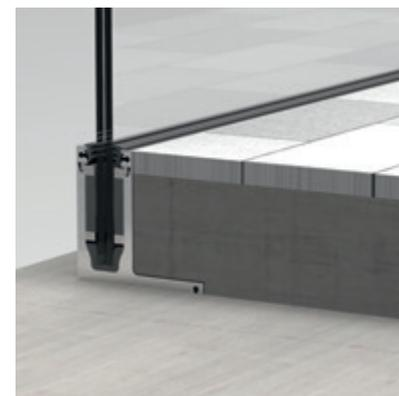
8. Fertiges System mit Estrich
