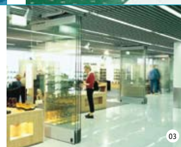
02. | 03. Wenn selbst Glas nicht offen genug ist, lassen sich die Horizontal-Schiebewände komplett öffnen und unauffällig an einer Seite des Eingangsbereiches parken.
